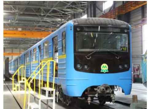
在克留科夫车辆工厂组装的 装备了日本产AC驱动装置的地铁改造车辆
