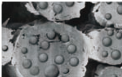
纤维中织入了 OUTLAST® 微胶囊的材料
