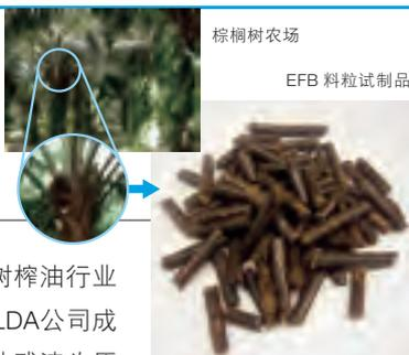
伊藤忠商事与棕榈树榨油行业的世界巨头马来西亚FELDA公司成立合资公司，以棕榈榨油残渣为原料制造固体生物燃料（EFB料粒）。制造的EFB料粒供应给日本电力公司，计划作为煤发电锅炉的煤炭替代燃料使用。废弃物的燃料化是具有划时代意义的试验，EFB料粒的商业化运作尚属世界首例。我部通过生物燃料的引进为全球变暖问题做贡献。
