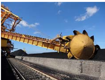
巨大的取料机一面运转，一面将煤炭装载到皮带输送带上
