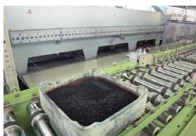
把原料混合起来放入容器中，架放在类似烤炉的烧结机里。
