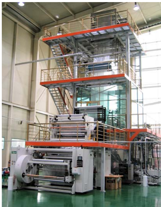
MACRO 公司(加拿大)产“薄膜制造设备” (用于食品包装等阻隔性强的多层膜的生产)
