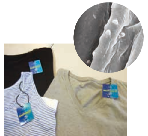
「DeoPowerTF」を採用したTシャツ（右上は電子顕微鏡で見た繊維にマイクロカプセルが付着した状態）
