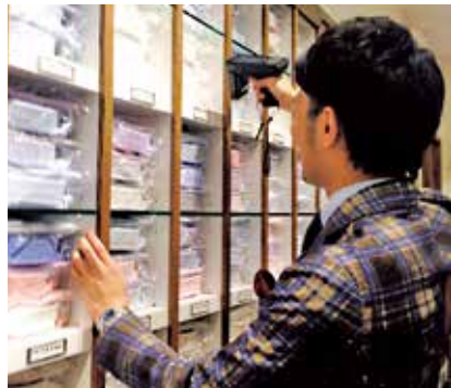
ハンディリーダーによるRFIDタグの読み取り作業
