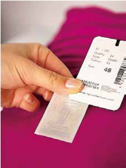
RFID タグには IC チップと小型のアンテナが組み込まれている。
