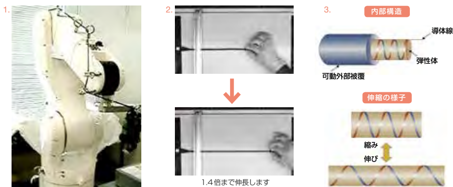
1.「ロボ電」は産業用ロボットの配線などを大幅に改善できる。 2.ストレートな形状のまま1.4倍まで伸長する伸縮性能。 3.弾性体「ロイカ」に電流の通る導体線をコイル状に組み込むことで伸縮性を確保する。
