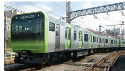
共通プラットフォームによる量産効果で、品質に優れ、コストも低減できる「sustina」は、数多くの鉄道会社の通勤車両として採用されている。(写真は山手線E235系)
