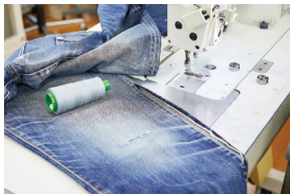
ジーンズに合った複数の色や太さの糸を使いながら、目立たないことを目指して補修する。
