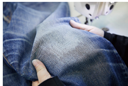
糸がデニムの組織を横断しないよう丁寧に補修するため、リペアの跡が目立たない。
