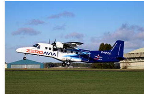
19人乗り機体「Dornier 228」に ZeroAvia 社の開発する水素燃料電池エンジンを搭載しデモフライト
