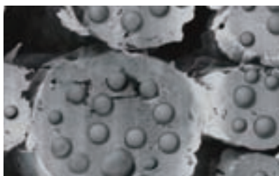
ファイバーの中にアウトラストマイクロサーマル・カプセルが組み込まれた素材
