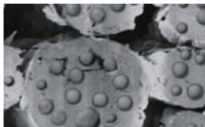
ファイバーの中にアウトラストマイクロサーマル・カプセルが組み込まれた素材
