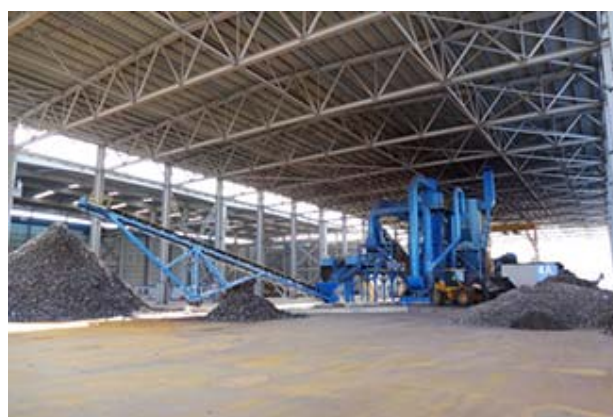
最新鋭の超大型シュレッダー（粉碎機）設備はアメリカ製で6000馬力を誇る
