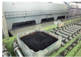
原料を混合して容器に入れ、オープンのような焼成機械にかけていく
