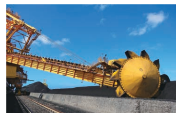
大きなリクレーマが回転しながら、石炭をベルトコンベアに乗せる
