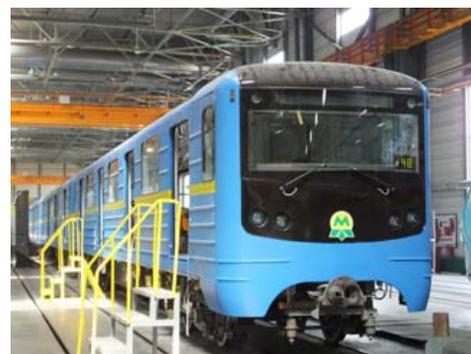
クリュコフ車両工場で組立てられた日本製AC駆動装置を装備した地下鉄改造車両
