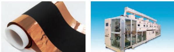
(左) 負極部品 / (右) 伊藤忠商事の出資先である株ヒラノテクシード製LiB電極用塗工装置。伊藤忠商事は塗工装置をはじめLiB各種製造装置を国内外に販売している
