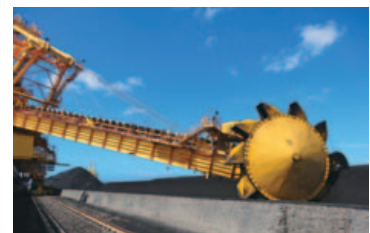
大きなリクレーマが回転しながら、石炭をベルトコンベヤに乗せる
