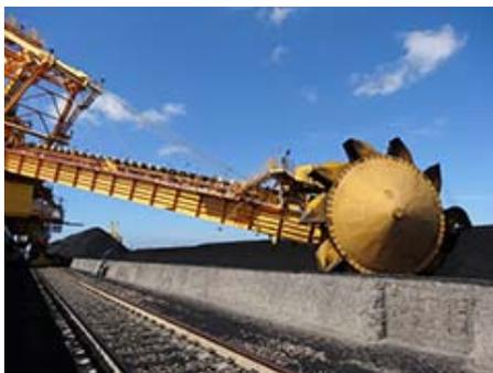
大きなリクレーマが回転しながら、石炭をベルトコンベヤに乗せる
