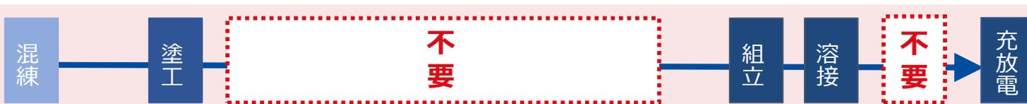
部材点数の削減 ➡ 現行プロセス比 ▲25%の部材コスト削減
